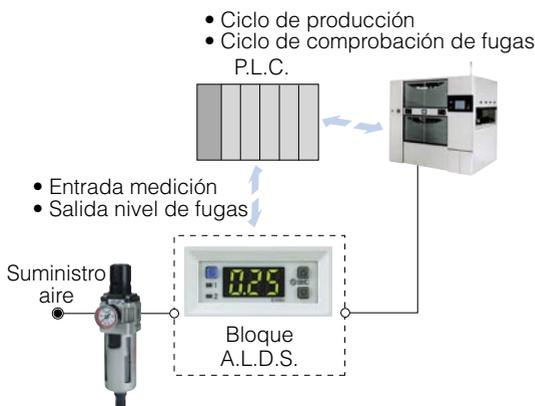
Mediante el uso de un "ciclo de comprobación de fugas" programado, es posible monitorizar cada uno de los circuitos de una máquina de forma individual, comparando los resultados con los registros previamente almacenados en el PLC. Dichos registros se pueden publicar posteriormente en un informe para el departamento de mantenimiento, garantizando así la máxima eficacia tanto en la detección de fugas como en el potencial ahorro de energía.
